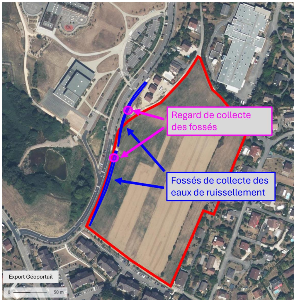
Figure 3 : Localisation des fossés existants
