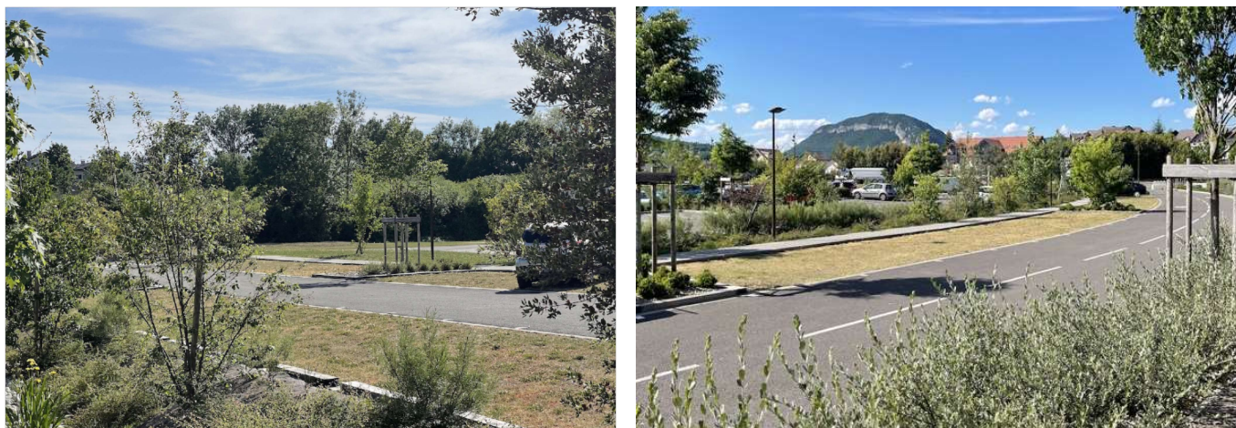
Exemple de stationnement perméable et paysager réalisé sur Parc'Espace en evergreen ( mélange de graminées, sedum, thym, ... )
