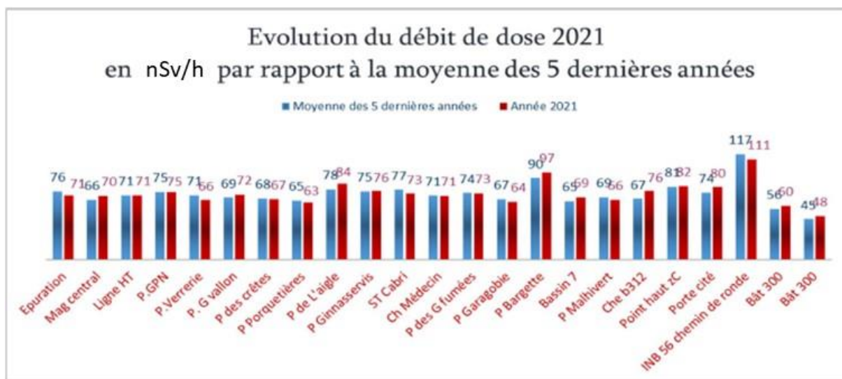
Figure 31 : Comparaison des valeurs annuelle moyennes de dosimétrie ambiante (nSv/h) mesurées en clôture du site pour 2021, aux valeurs moyennes des 5 dernières années
