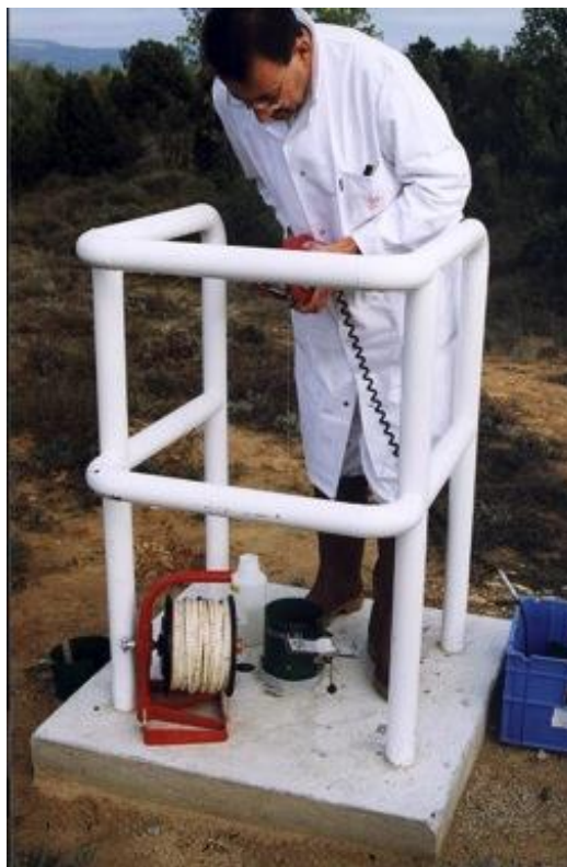
Surveillance d'un piézomètre
