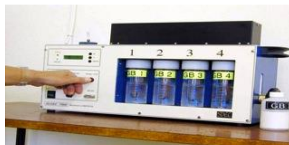
Barboteur pour la mesure du tritium
