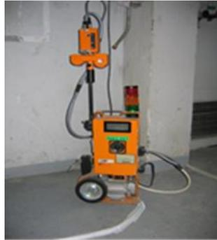
*Figure 8. Exemple d'un appareil de surveillance radiologique de chantier*
