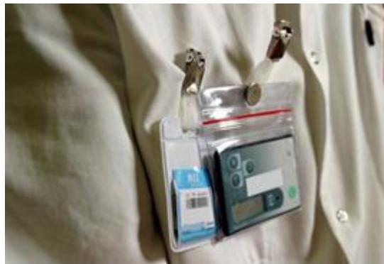
*Figure 9. Exemple dosimètre passif (gauche) et dosimètre opérationnel (droite)*
