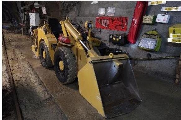
**Figure 4 : Photographie du chargeur CTX**
