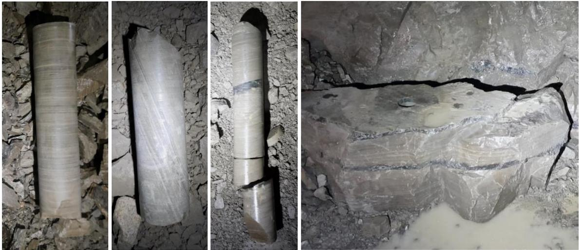
Figure 5 : Exemple de carottages perpendiculaires/obliques et bloc échantillonnés
