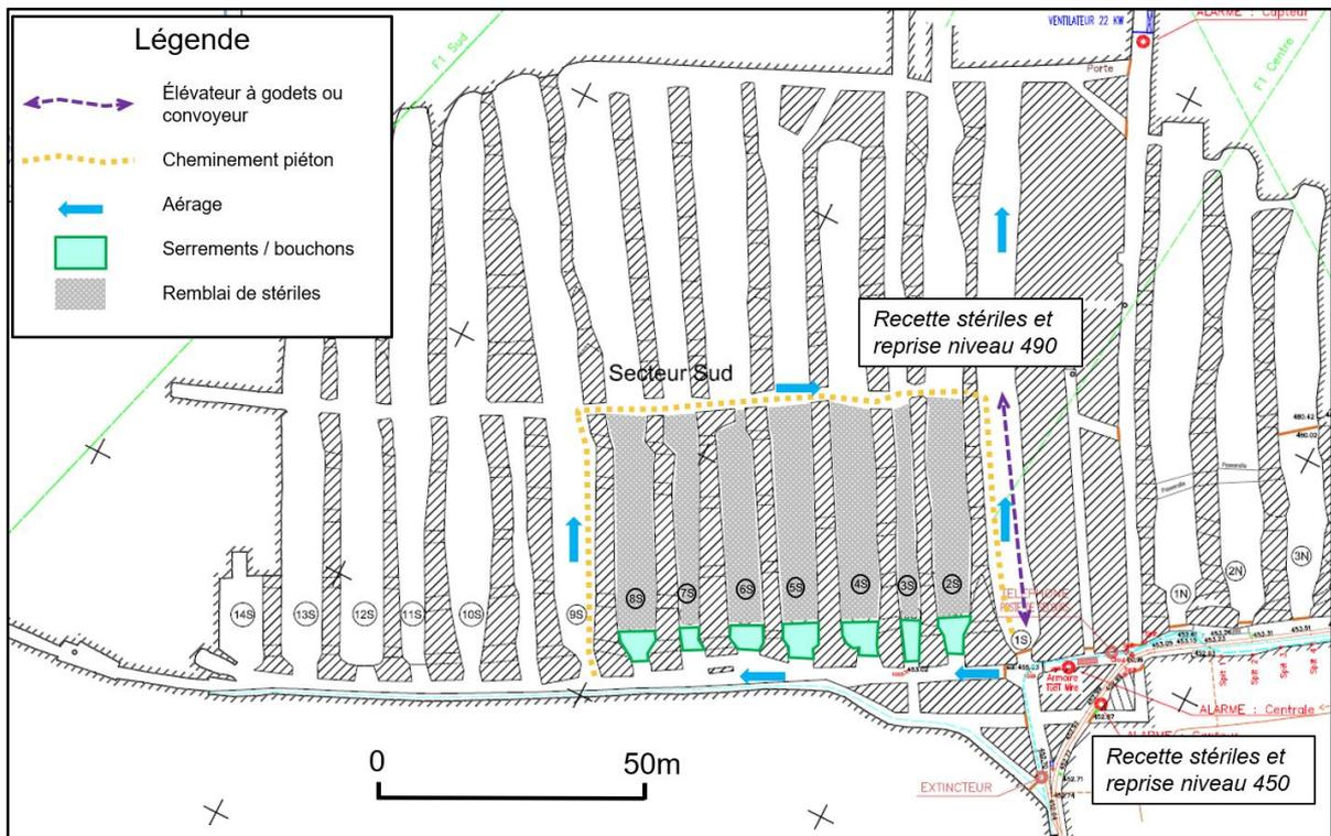
Figure 2 : Plan de principe du remblaiement dans le quartier Sud.
