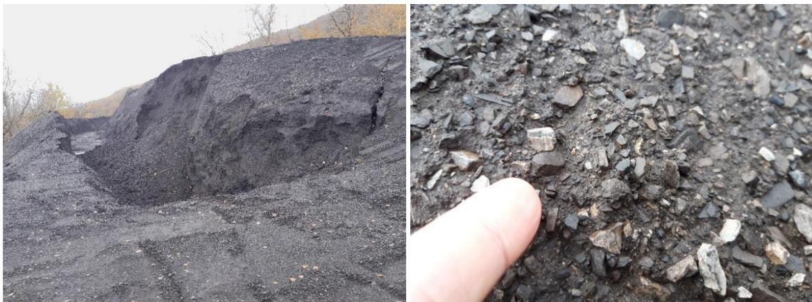
Figure 1 : Stériles de la mine d'Orbagnoux, actuellement stockés en extérieur sur site.
