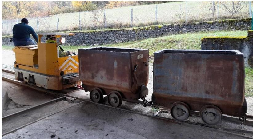
Figure 7 : Locomotive et wagonnets actuellement utilisés pour la production.
