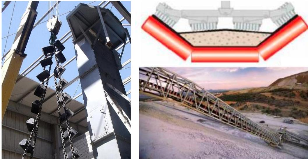
Figure 6 : Exemple d'élévateurs à godets et convoyeur grand angle (HAC)
