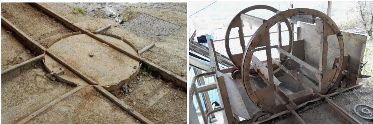
Figure 5 : Dispositifs de rotation et basculement des wagonnets, existants en extérieur à Orbagnoux.
