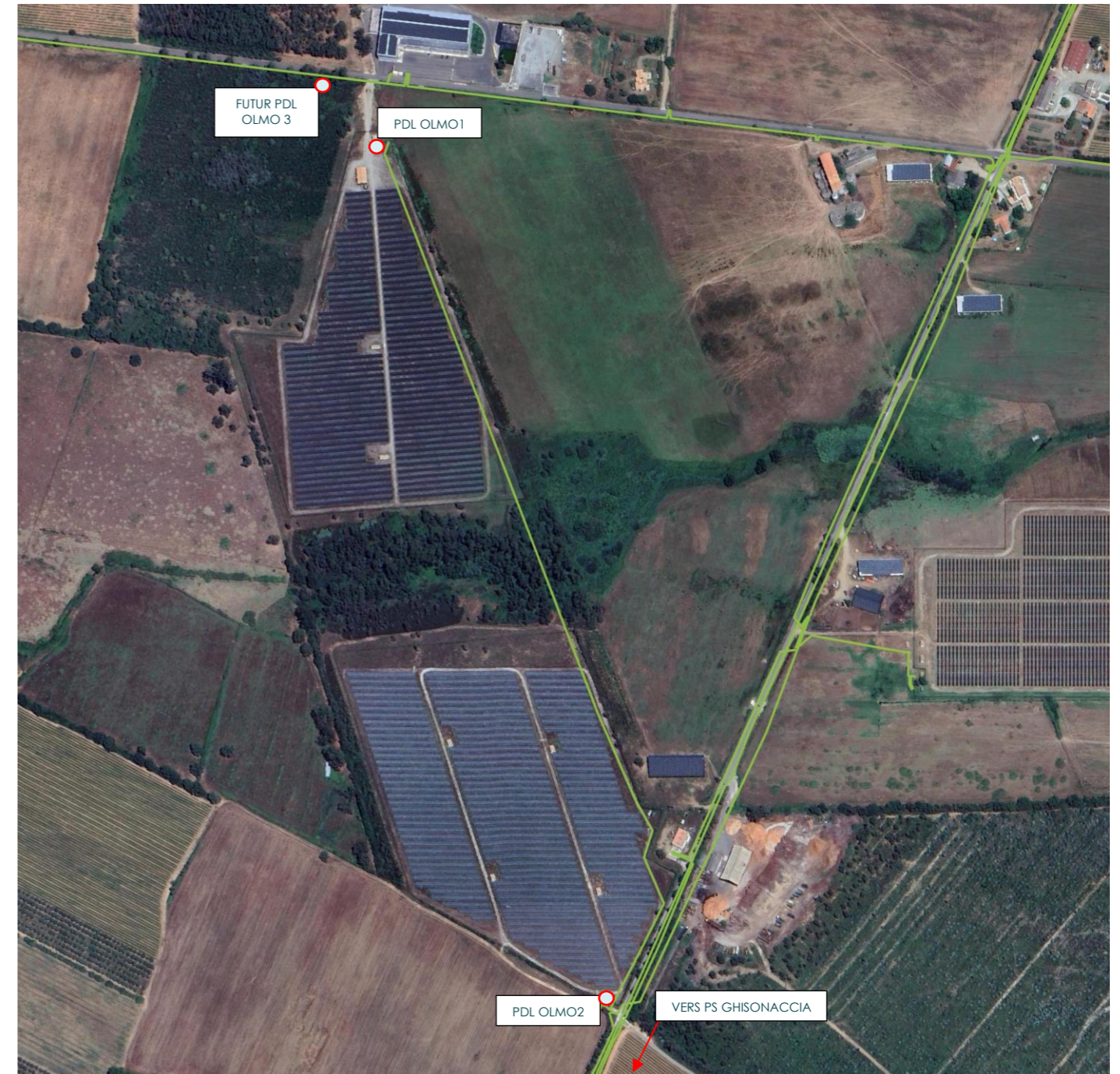
Figure 6 : Réseaux HTA (en jaune) et liaison HTA entre le poste de livraison d'Olmo 1 jusqu'au poste de livraison d'Olmo 2 (source : Akuo)
