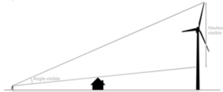
FIGURE 8. Angle vertical visible de dépassement du projet éolien
