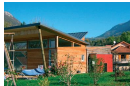
Un dépassé de toiture bien conçu permet de réguler l'ensoleillement en fonction des saisons.
