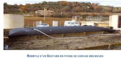
Les boues (produits issus des process pour purifier l'eau de mer en eau potable) sont traitées à l'aide de géotubes directement sur site.
