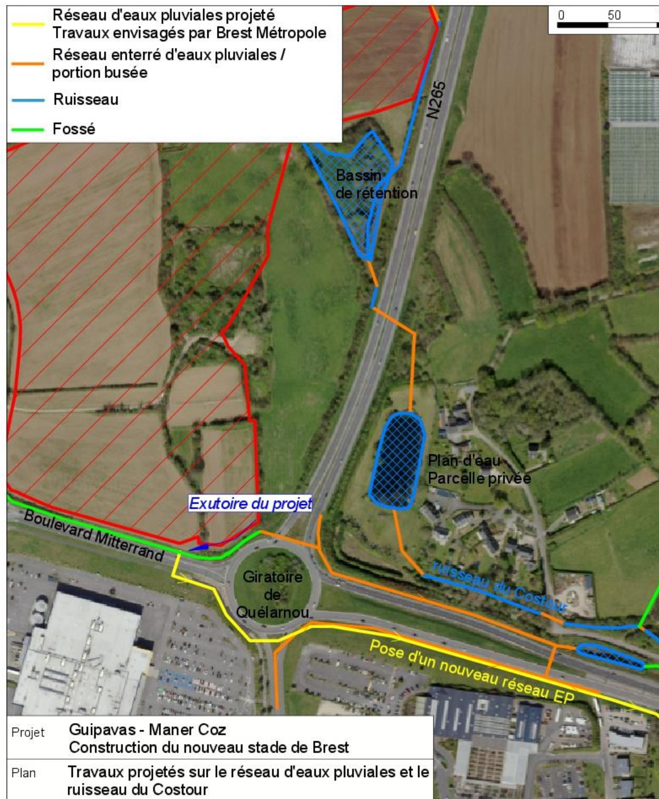
Carte 10 : Travaux sur le réseau d'eaux pluviales et le ruisseau du Costour projeté par Brest Métropole (EGEO, 2024)
