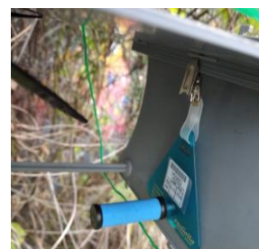
Figure 10 : Exemple de radiello dans sa cabane de protection
