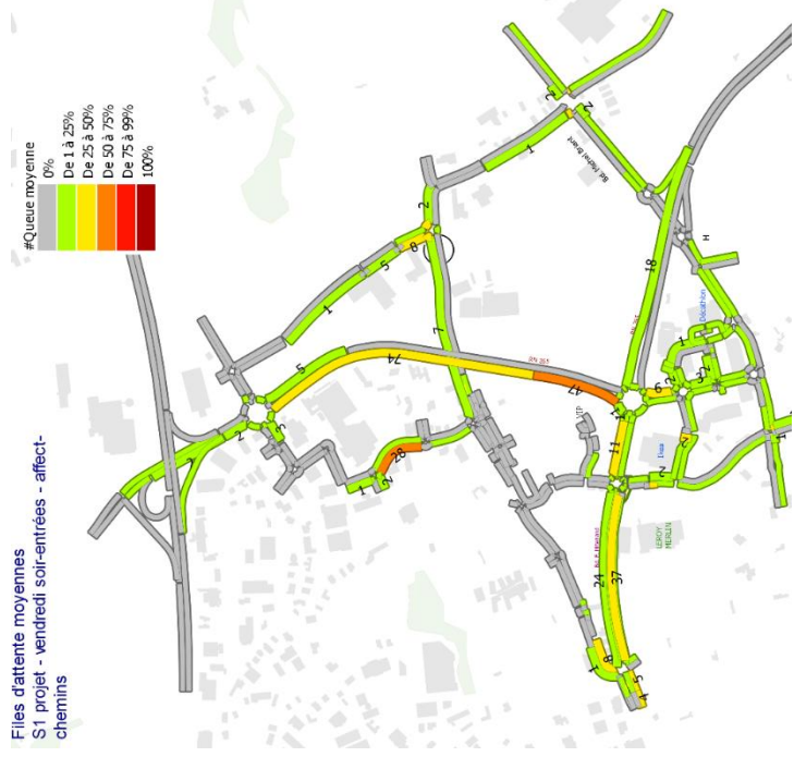
Figure 41 : remontées de file moyenne - variante 2- test2 - sollicitation plus importante de la RN265
