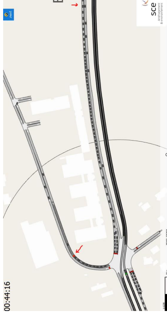
Figure 35: extrait de la modélisation variante 1- test 1 remontées de file – vendredi soir
