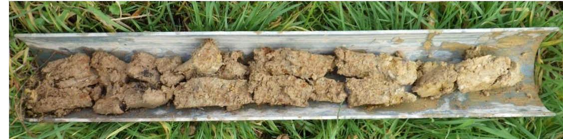
Figure 39 : Sondage pédologique n°83 caractéristique de zones humides (traits rédoxiques dès la surface)
