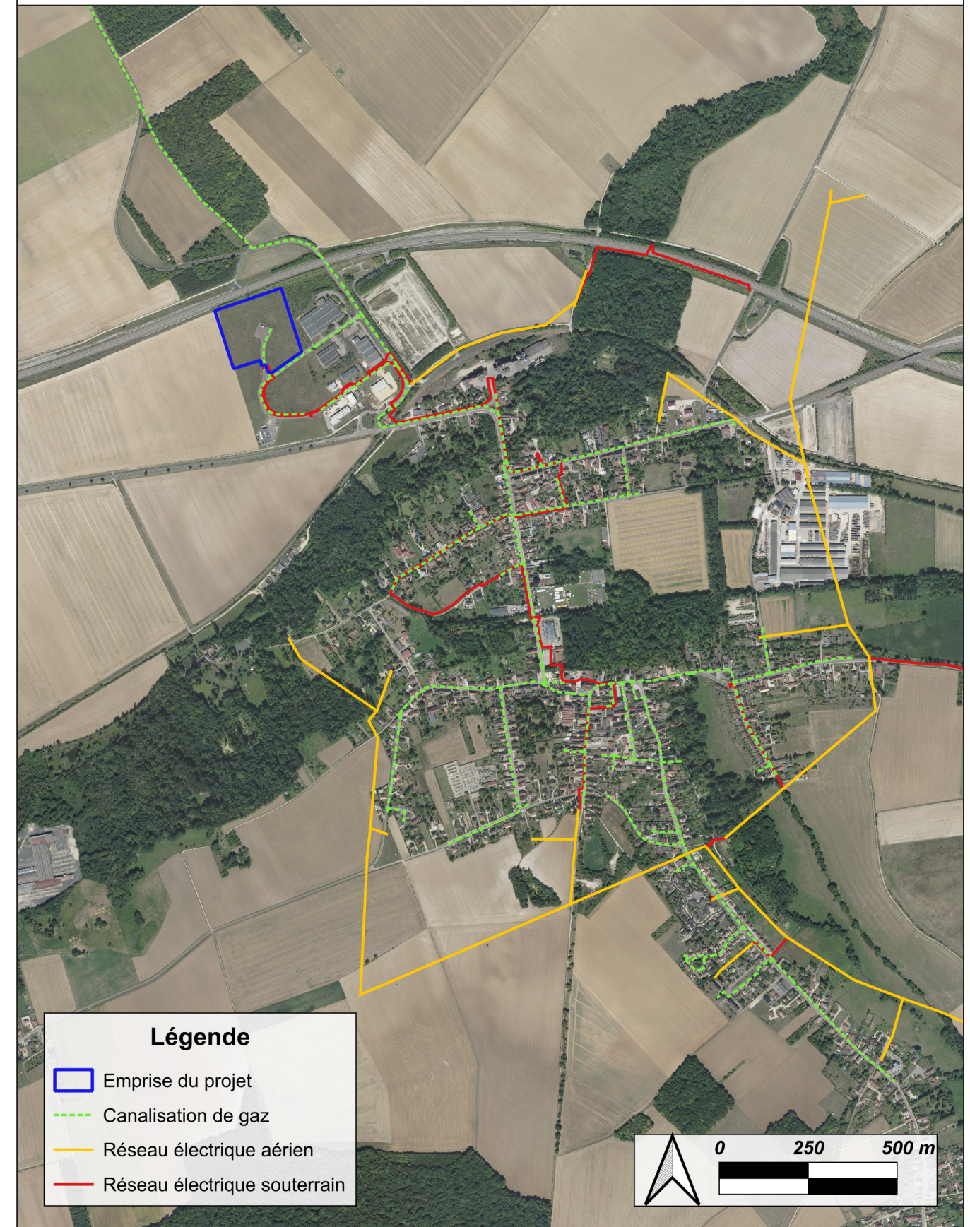
Figure 51 : Localisation des réseaux au droit du site
