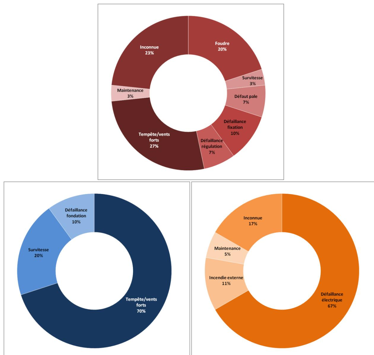
Figure 7 : Répartition par cause des principaux événements accidentels sur le parc éolien français entre 2000 et 2019
