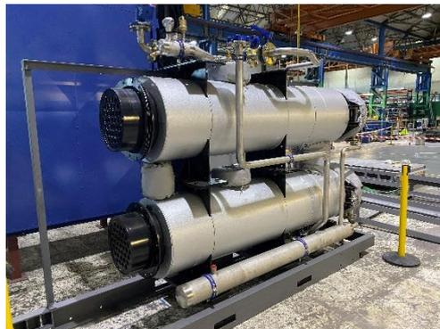
Les gaz de fumée du four pyrolytique entrent dans le refroidisseur de gaz de combustion et sont refroidis à la plage de température de fonctionnement du filtre de 120°C à 150°C. La chaleur retirée des gaz de fumée est transférée par un système de circulation d'eau / éthylène glycol à un refroidisseur d'air (aérotherme) dédié situé à l'extérieur de l'équipement de filtration.
