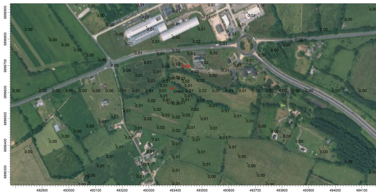
Figure 2-12 : Cartographie de la dispersion atmosphérique des PM2,5 - Concentrations moyennes dans l'air sur la période de modélisation (en \mu\text{g}/\text{m}^3 )
