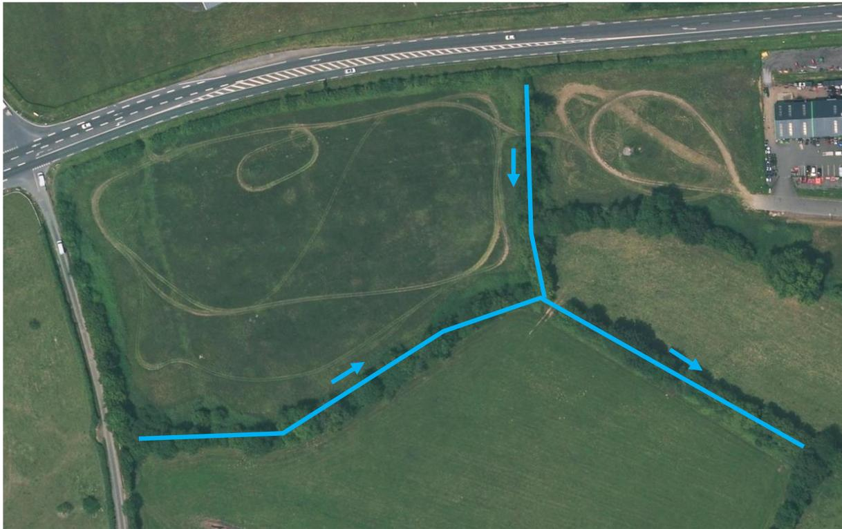
Figure 20. Localisation des fossés avec sens d'écoulement
