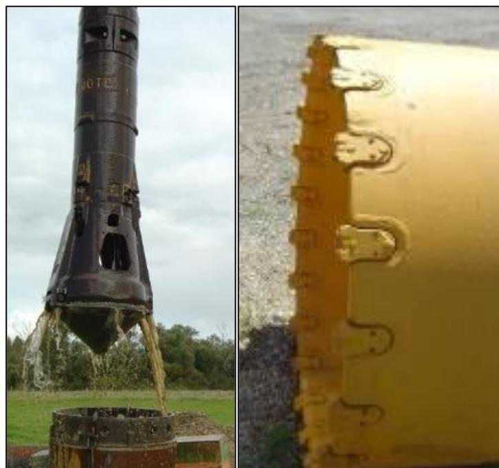
Figure 3 : Photographies d’une benne BENOTO et d’un sabot (RESURGENCE)
