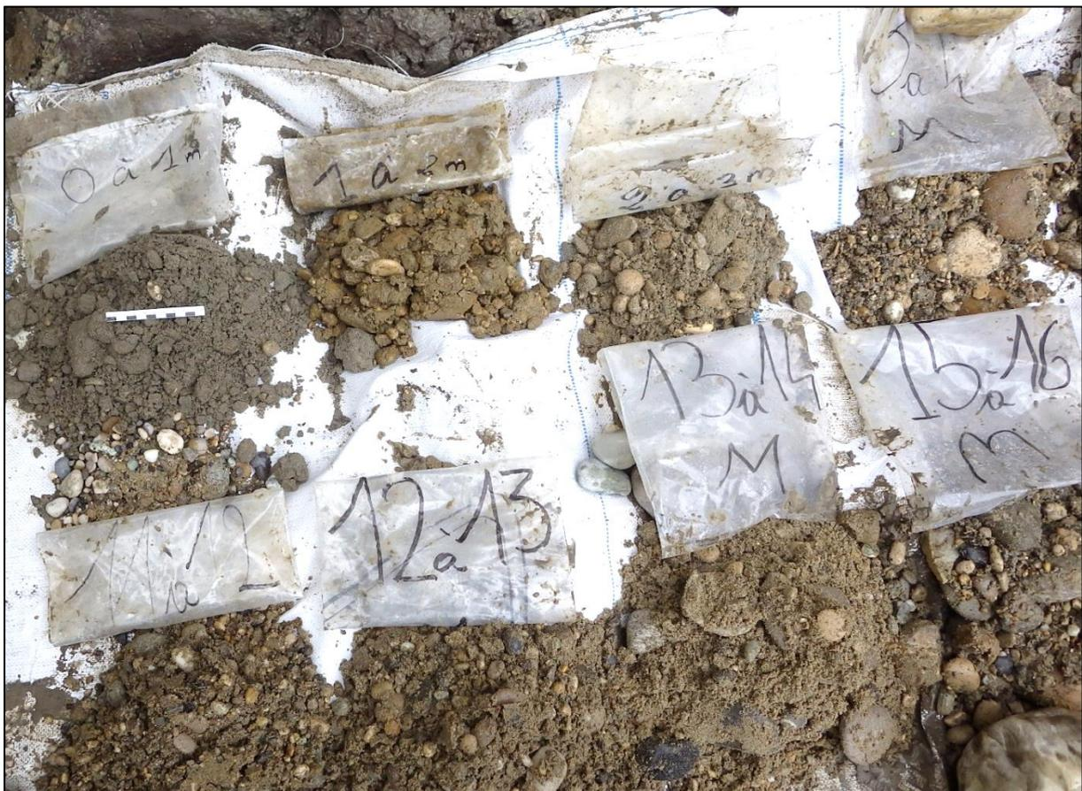
Figure 4 : Photographies d’échantillons récupérés par la méthode BENOTO
