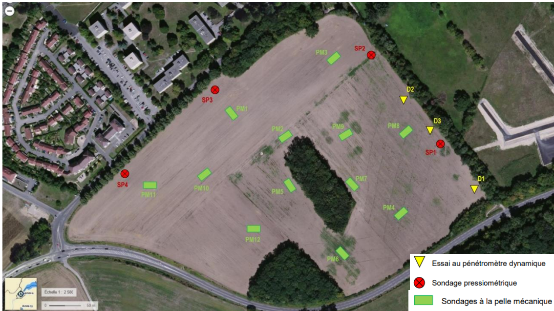
Figure 62 – Schéma d'implantation des sondages, G2PRO, Ginger, février 2022
