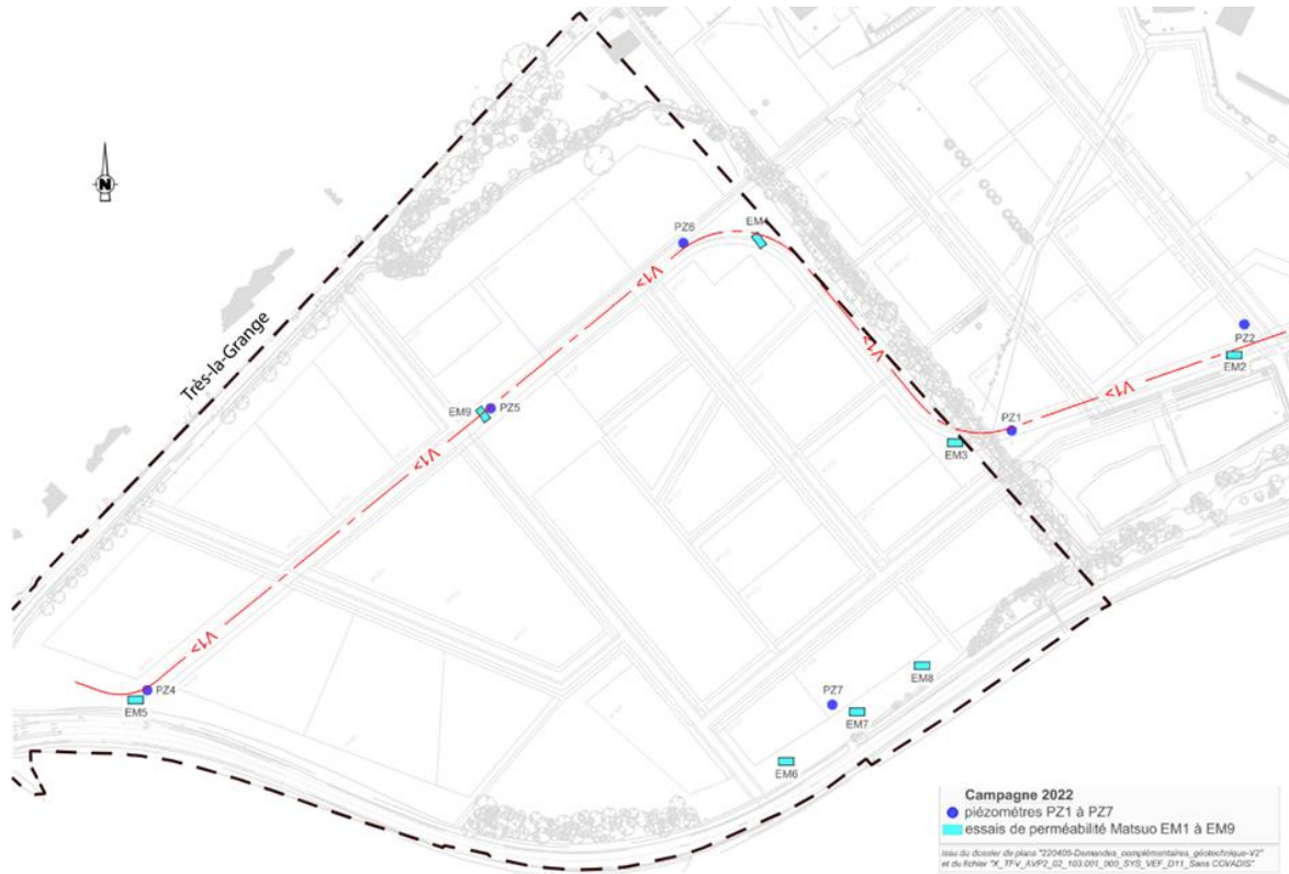
Figure 64 – Implantation des piézomètres et essais Matsuo sur le secteur Très-la-Grange, Ginger CEBTP, octobre 2022
