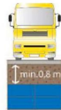
Figure 32 - Hauteurs des remblais sur le bassin SAUL, Notice technique, PRO Véloroute, ALTO STEP, juin 2021
