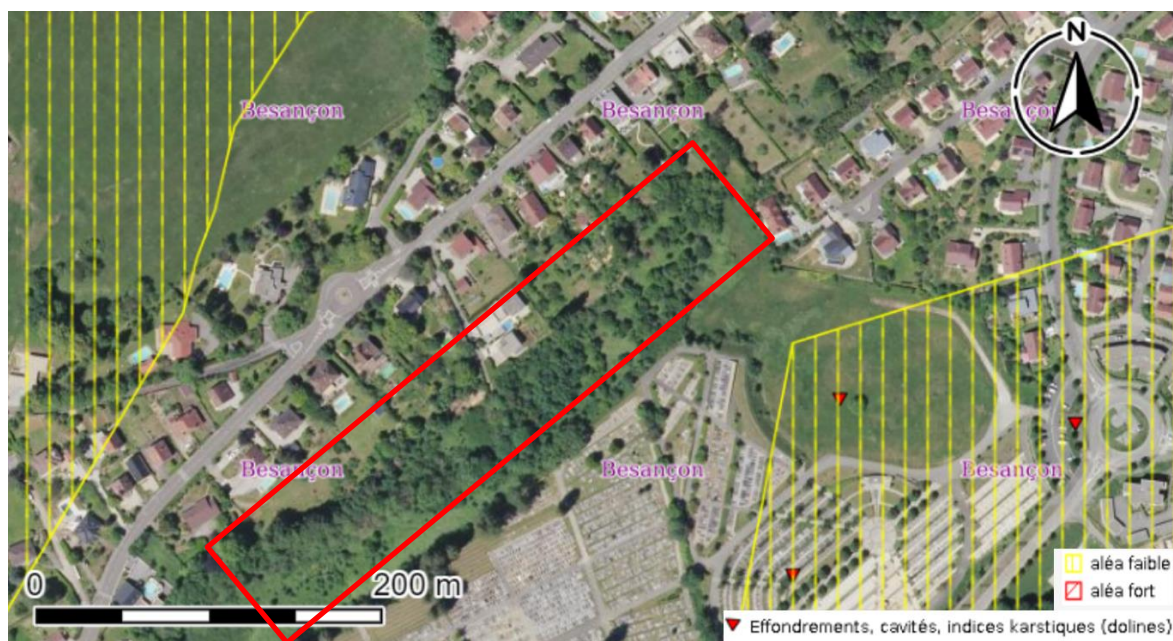
Figure 17 : Extrait de la carte d'indices karstiques et des mouvements de terrain (aléa effondrement) - Carto2.geo (DDT25)
