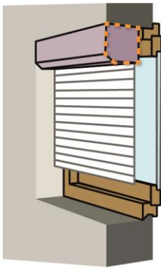
POSE SOUS LINTEAU
