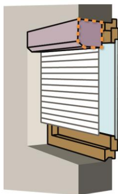
POSE SOUS LINTEAU
