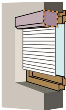
POSE SOUS LINTEAU
