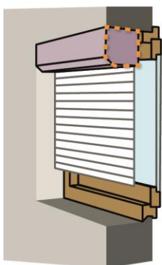
POSE SOUS LINTEAU
