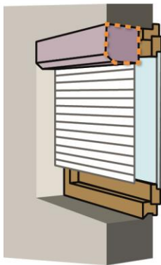
POSE SOUS LINTEAU
