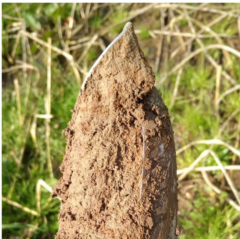
Sol présentant des traces d'hydromorphie à Bocneuf-la-Rivière, le 16/04/2024 (= traces de couleur ocre traduisant de l'état oxydé du fer naturellement présent dans les sols et caractéristique de la présence d'eau suffisamment longtemps pour justifier du classement réglementaire en zone humide)
